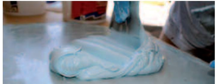
I due componenti dello stucco Epomast pro devono essere miscelati fino ad ottenere un colore omogeneo.
